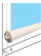
1) Guidatura per fissaggio a terra
